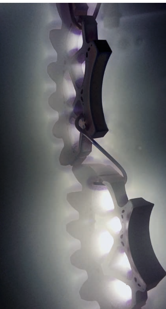
Additiv gefertigte Bauteile bei der Feinstreinigung im Niederdruckplasma
