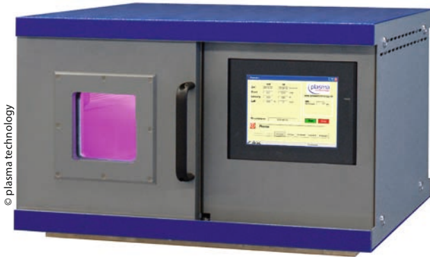
Kompaktanlage mit 32 Liter Kammervolumen, platzsparender Schiebetür, Mikrocontroller gesteuert mit Industrie PC zur Visualisierung, Prozessüberwachung und -dokumentation, Massflowcontroller sowie maximal zwei Gaskanälen und 600 W Generatorleistung
